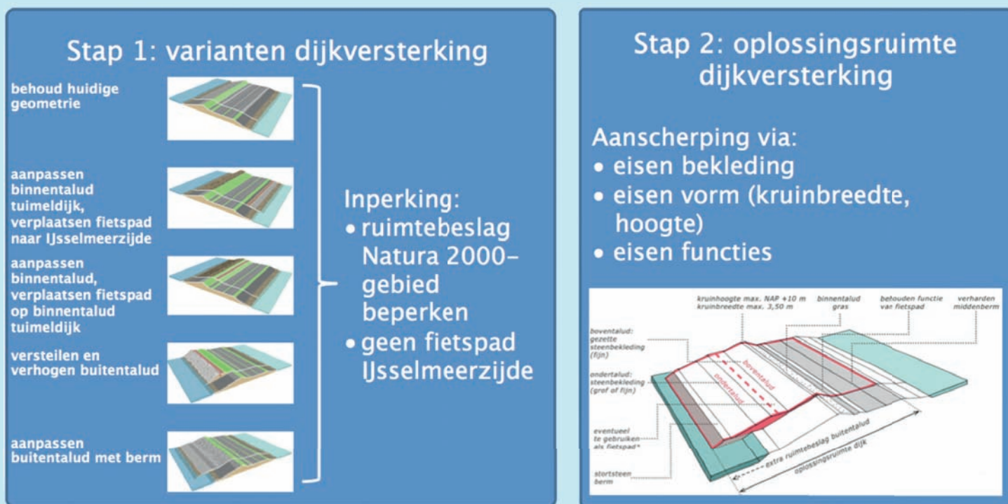
Figuur 4. Visualisatie uitwerking stap 1 en 2 voor het onderdeel dijklichaam
